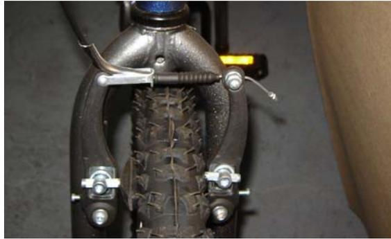
Figura 3: sistema de freno V-Brake.
