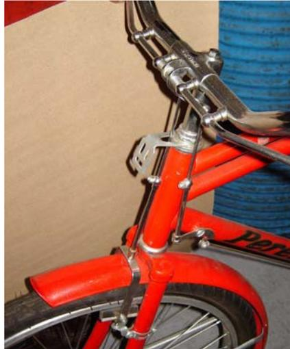
Figura 4: sistema de freno a varilla.
