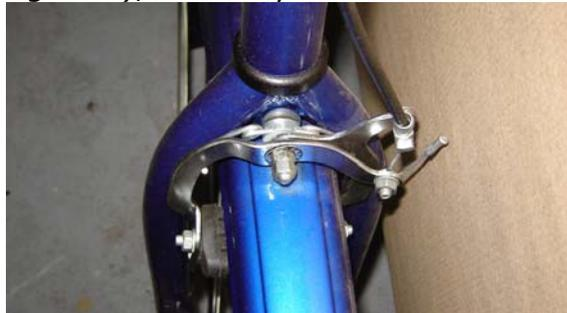
Figura 1: sistema de freno a herradura.
