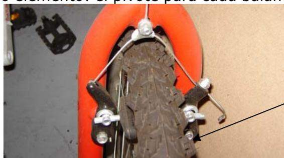
Figura 2: sistema de freno Cantilever.
